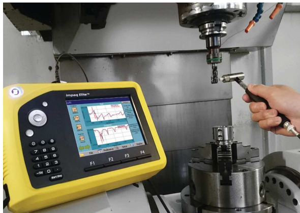
ハンマリング試験で工作機械の刃の周波数応答関数を測定
